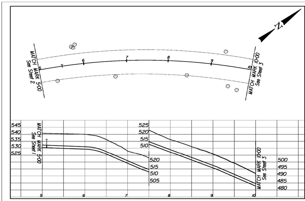
**FIGURE 2.16.3: TYPICAL MATCH MARK A FOR VERTICAL SHIFT**
