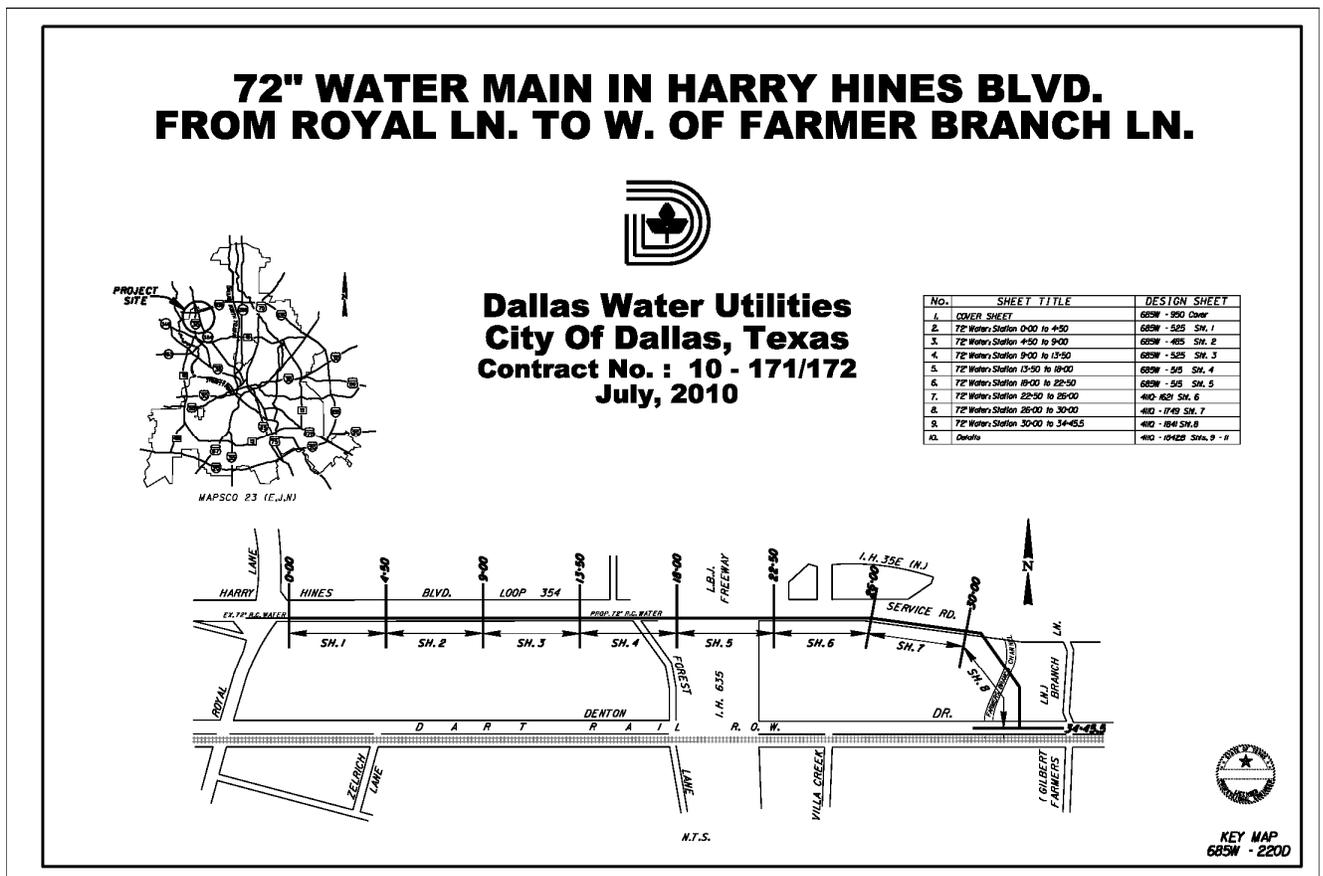
**FIGURE 3.3.1: TYPICAL COVER SHEET FOR A MAJOR SINGLE UTILITY PROJECT**
