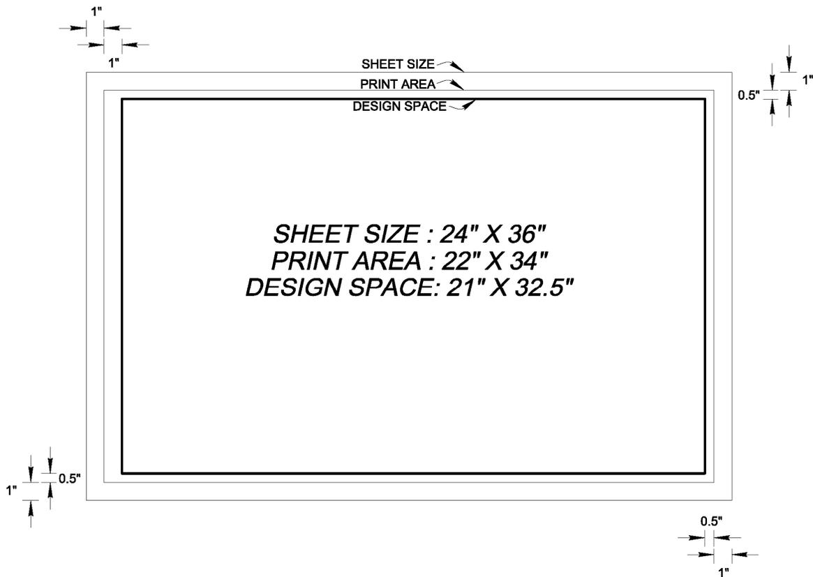
FIGURE 3.5.1 STANDARD DESIGN SHEET BORDER
