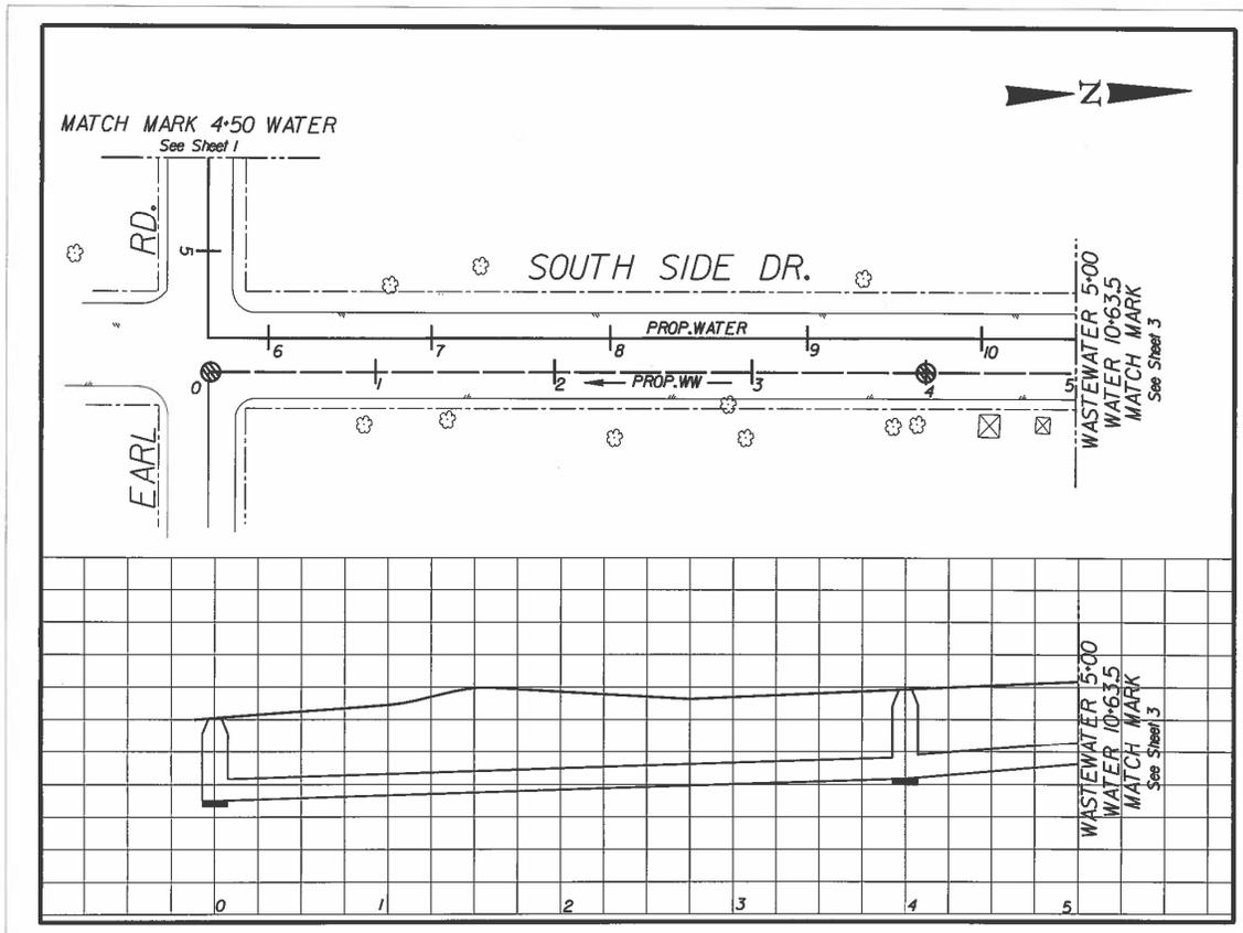
**FIGURE 2.16.2: TYPICAL MATCH MARKS FOR A COMBINED UTILITY PROJECT**
