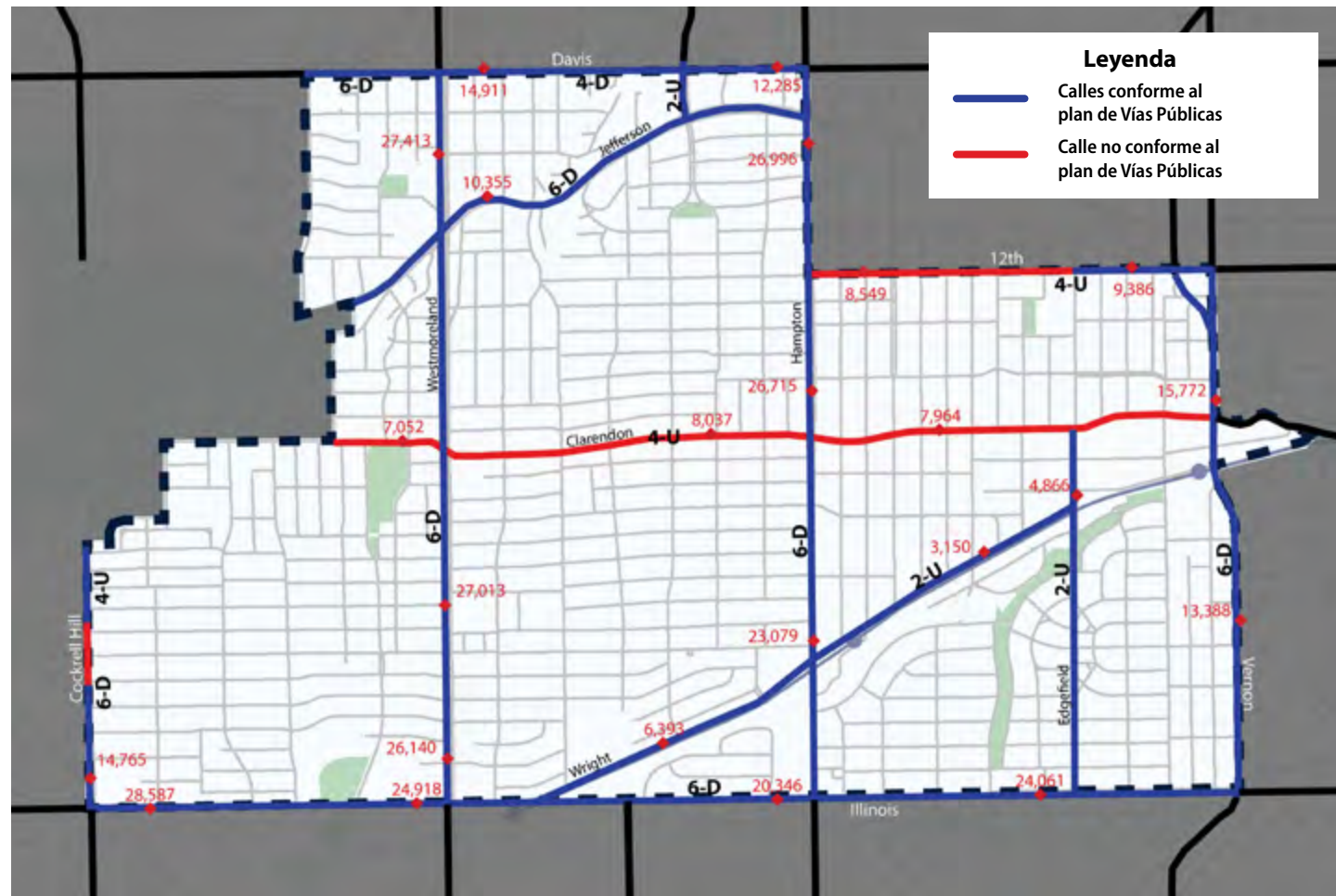
Plan de Vías Públicas de la Ciudad de Dallas para West Oak Cliff con recuentos de tráfico añadidos
